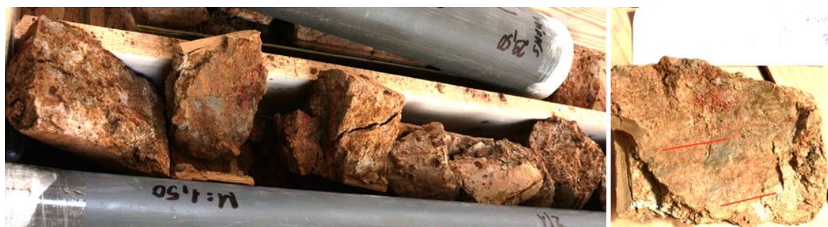
6. ábra. A Pa-21-B fúrásban 29,0–29,9 m között dokumentált, közel függőleges, eltolódási sík a Tengelici Formációban. A karcok dőlésszöge \sim 5^\circ (piros vonalakkal jelölve)
