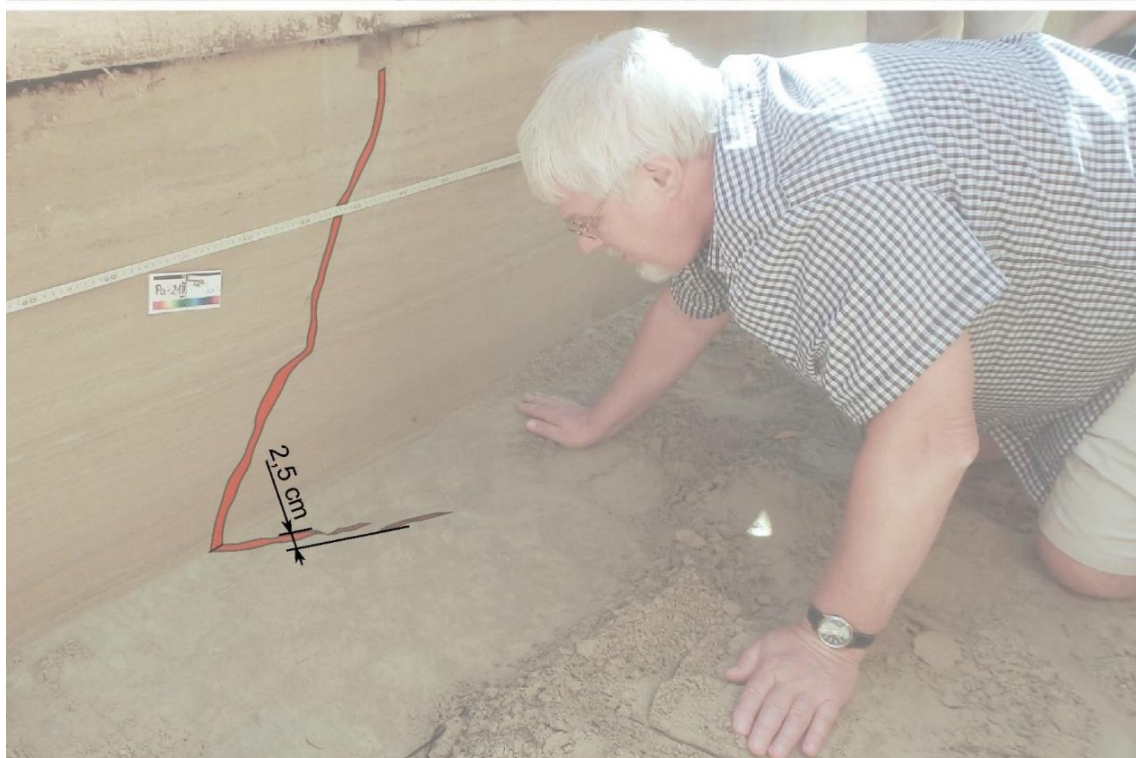
32. ábra. En echelon szerkezetet mutató, kiékelődő hasadék az árok 37. méterében.
