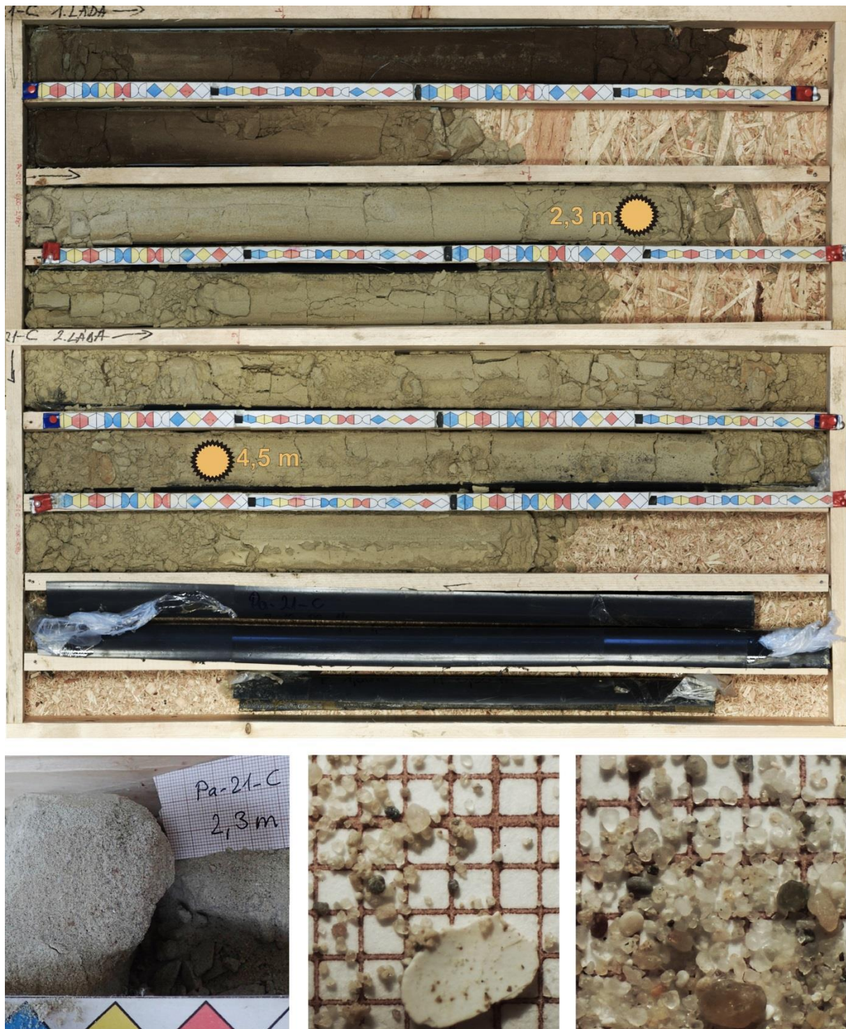
22. ábra. A ^{14}\text{C} kormeghatározásra vett minták helye a Pa-21-C jelű fúrásban (felső kép, sárga korong)
