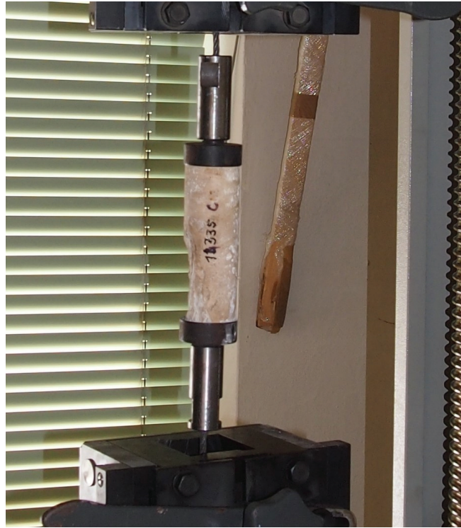
4.4. ábra: Egyszerű szakítószilárdság teszt egy szabályos mintatestté alakított, Detrekői-zsombolyból származó cseppkődarabon.
