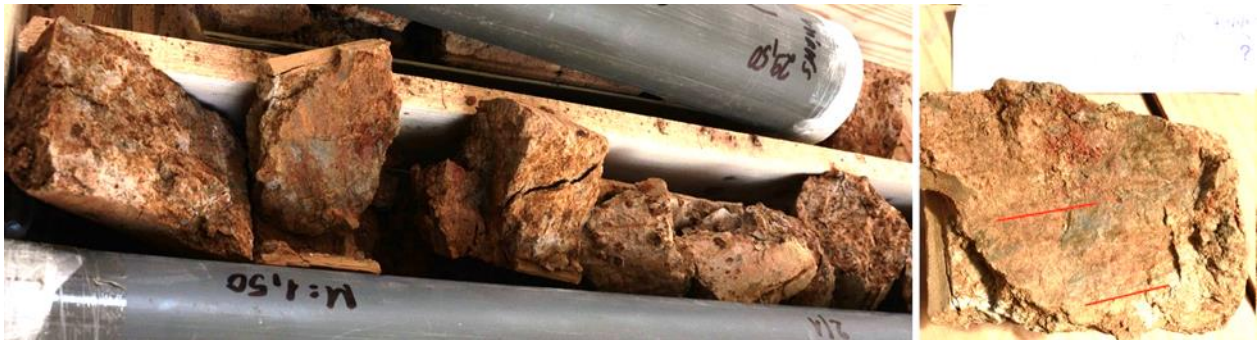
245. ábra A Pa-21-B fúrásban, 29 m környékén dokumentált, közel függőleges, jobbos eltolódás a Tengelici Formációban
